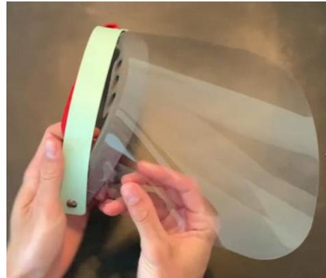
5. Schieben Sie die Blende nun so wieder herunter, dass die Blende mit dem Tragkörper oben bündig abschließt
